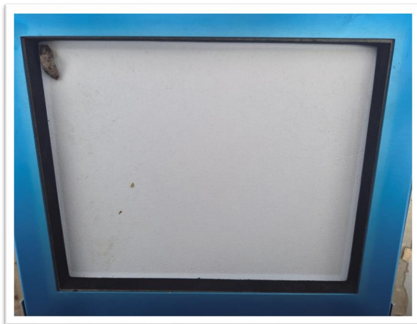
Figure 8 – Contaminated Hivol Sample
