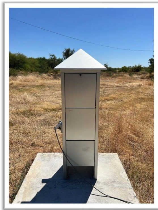
Figure 2 - HIVOL 3000 High Volume Air Sampler
